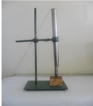
Նկ.4 Փայտանյութի հարվածային պնդությունը որոշող սարքի ընդհանուր տեսքը
